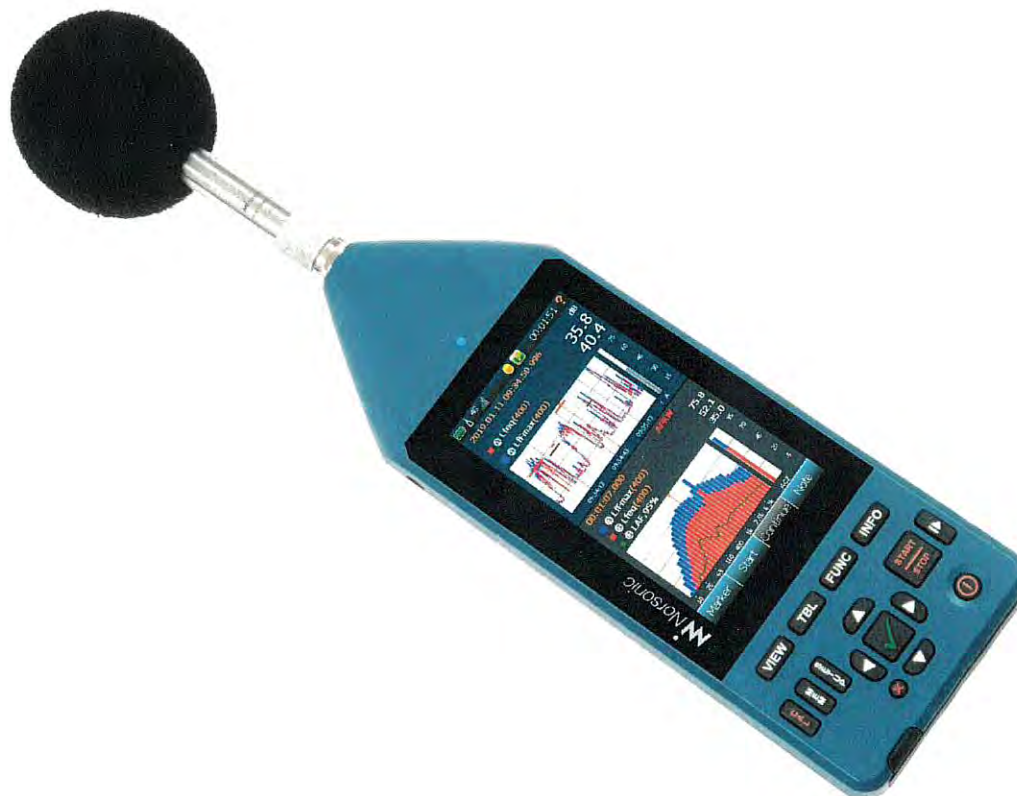
Abbildung 1: Nor145 mit aufgesetztem Mikrofon und Windschirm
