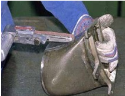
Figur 27: Alternativ til roterende slipemaskin. Båndsliper med vibrasjon 0,5 \text{ m/s}^2 .
