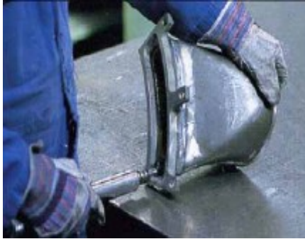
Figur 26: Roterende slipemaskin med vibrasjon 2 \text{ m/s}^2 .
