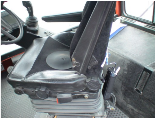
Plassering av akselerometeret med dataloggeren bak setet
