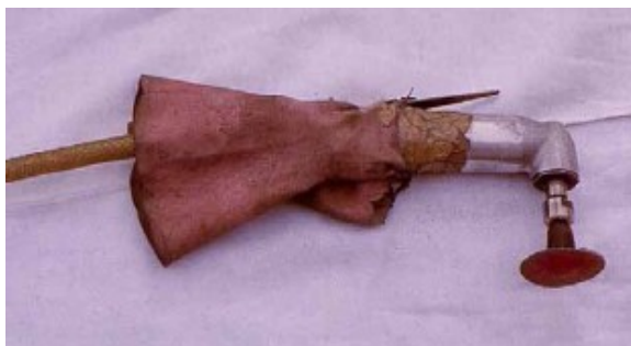
Figur 30: Slipemaskin med påtaptet gummimansjett for å hindre eksosutblåsing mot hendene.
